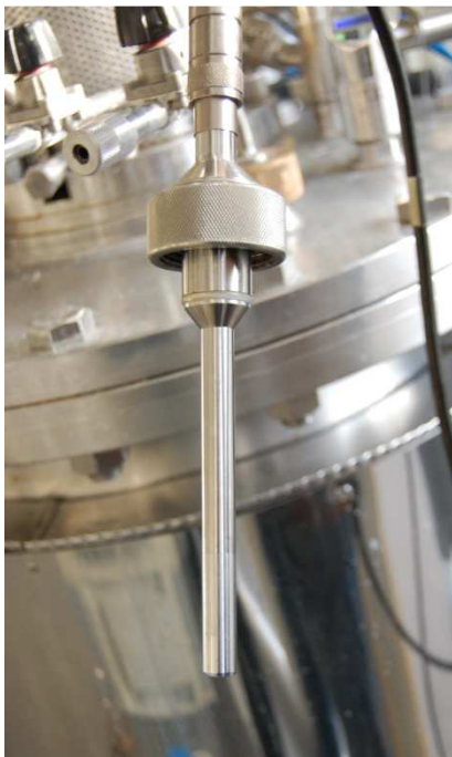
11. kép Oldott oxigén szenzor
