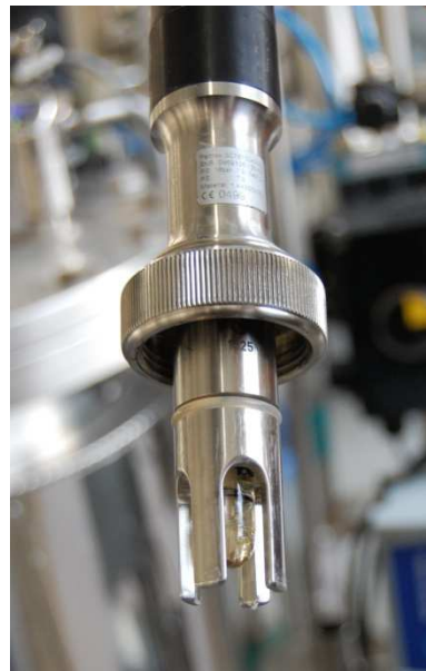
9. kép Kombinált pH elektróda
