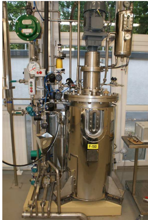
1. kép Debreceni Egyetem Kísérleti üzemének 150 literes fermentora
