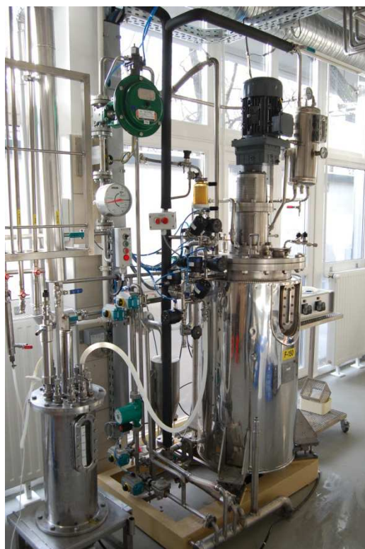
19. kép Oltás fermentorról fermentorra oltóköron keresztül
